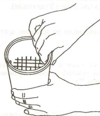
Способ извлечения вкладыша из корпуса.
