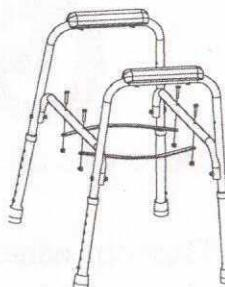
Закрепить на перекладинах планки-держатели ведра с помощью винтов M6 и гаек M6 со стопорным кольцом.
