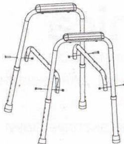
Закрепить на опорных конструкциях перекладины с помощью винтов M6 и гаек M6 со стопорным кольцом.
