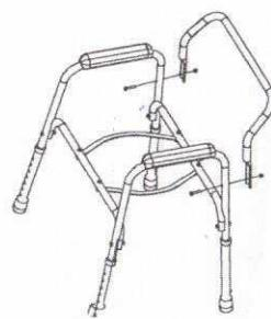
Установить спинку стула с помощью винтов M6 и гаек M6 со стопорным кольцом.
