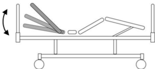
Спинная секция ложа может быть поднята или опущена от 0 до 80 градусов при помощи электропривода с пульта ручного управления
