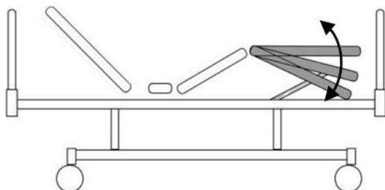
Икроножная секция ложа может быть поднята или опущена от 0 до 45 градусов при помощи электропривода с пульта ручного управления
