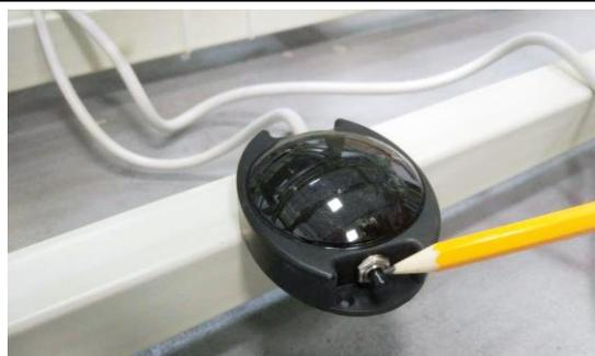
Одновременно зажимаем кнопку на приемнике, который находится в нижней части кровати
