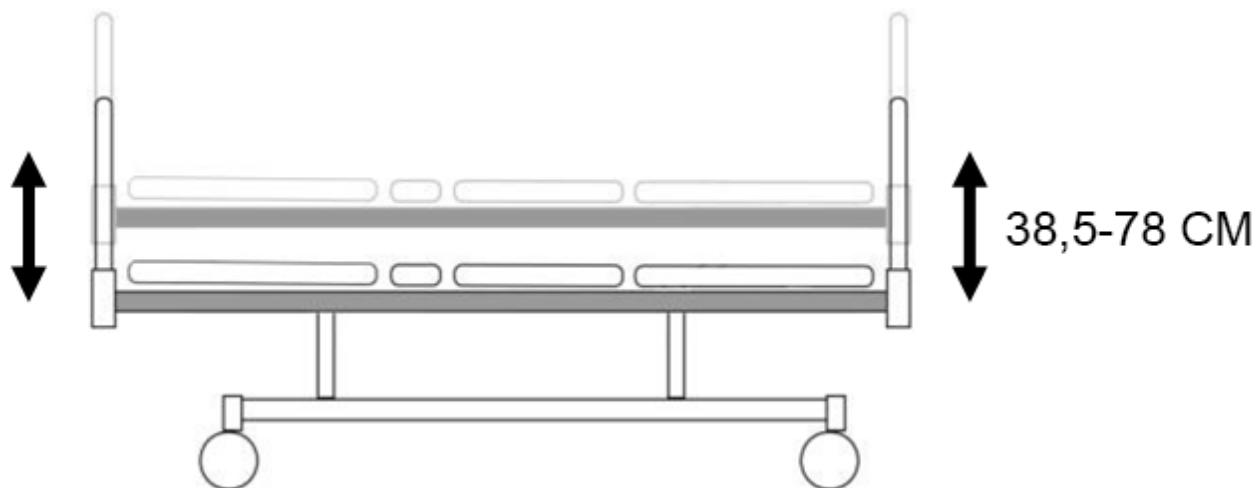
Кровать регулируется по высоте с помощью двигателей 24 В постоянного тока с пульта ручного управления и / или панели управления медсестры.
