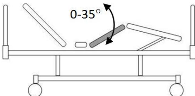
Бедренная секция может быть поднята до 35 градусов при помощи электропривода с пульта ручного управления и / или панели управления медсестры.
