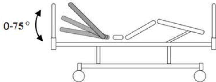
Спинная секция ложа может быть поднята до 75 градусов при помощи электропривода с пульта ручного управления и / или панели управления медсестры.
