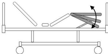
Ножная секция ложа изменяет угол наклона до 20 градусов
