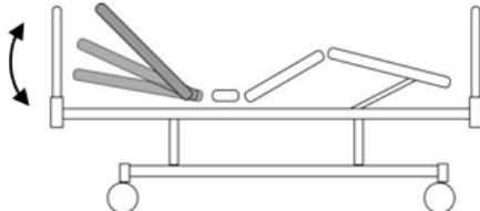
Спинная секция ложа может быть поднята до 80 градусов при помощи электропривода с пульта ручного управления.
