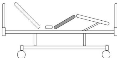
Бедренная секция может быть поднята до 45 градусов при помощи электропривода с пульта ручного управления.
